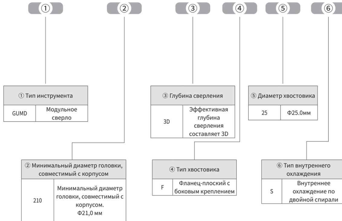
Система обозначения головки сверл GUMD
