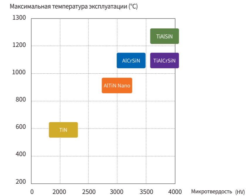
Взаимосвязь между микротвердостью и максимальной температурой эксплуатации
