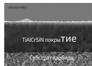
Фотография покрытия с помощью РЭМ (СЭМ)
