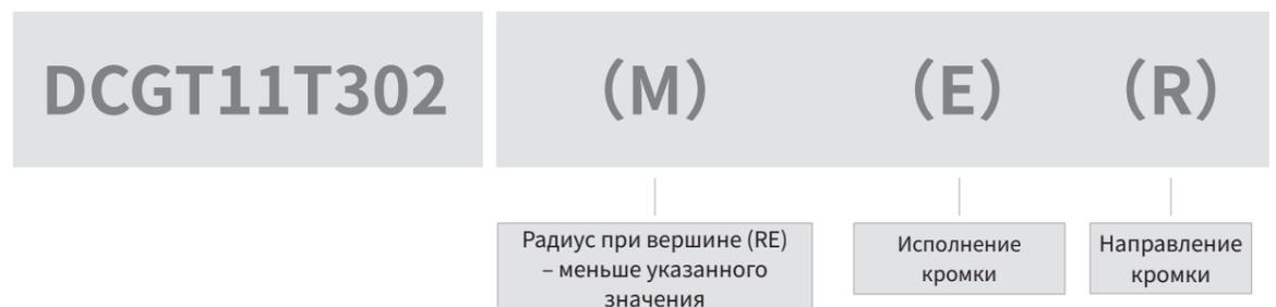
Токарные пластины для мелкоразмерной обработки (Негативные)
